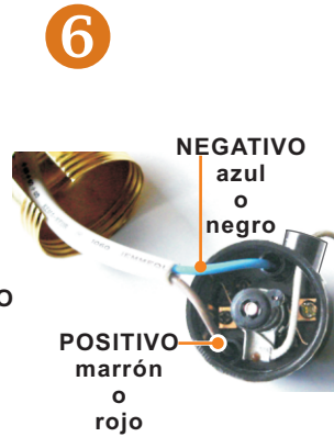
Pasar los cables a través de los taladros, respetando la polaridad indicada. Manipular con cuidado para que no salte el muelle del interruptor.
