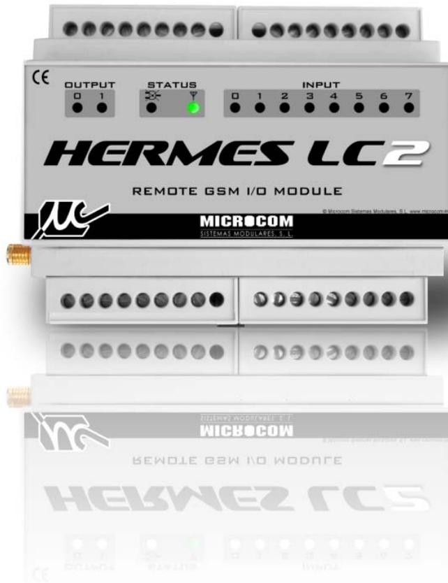
El **Hermes LC-2** es la segunda generación de nuestro exitoso modelo Hermes LC. Se trata de un sistema de telecontrol y telemetría basado en la tecnología GSM que permite monitorizar estaciones remotas de un modo sencillo y eficaz.
